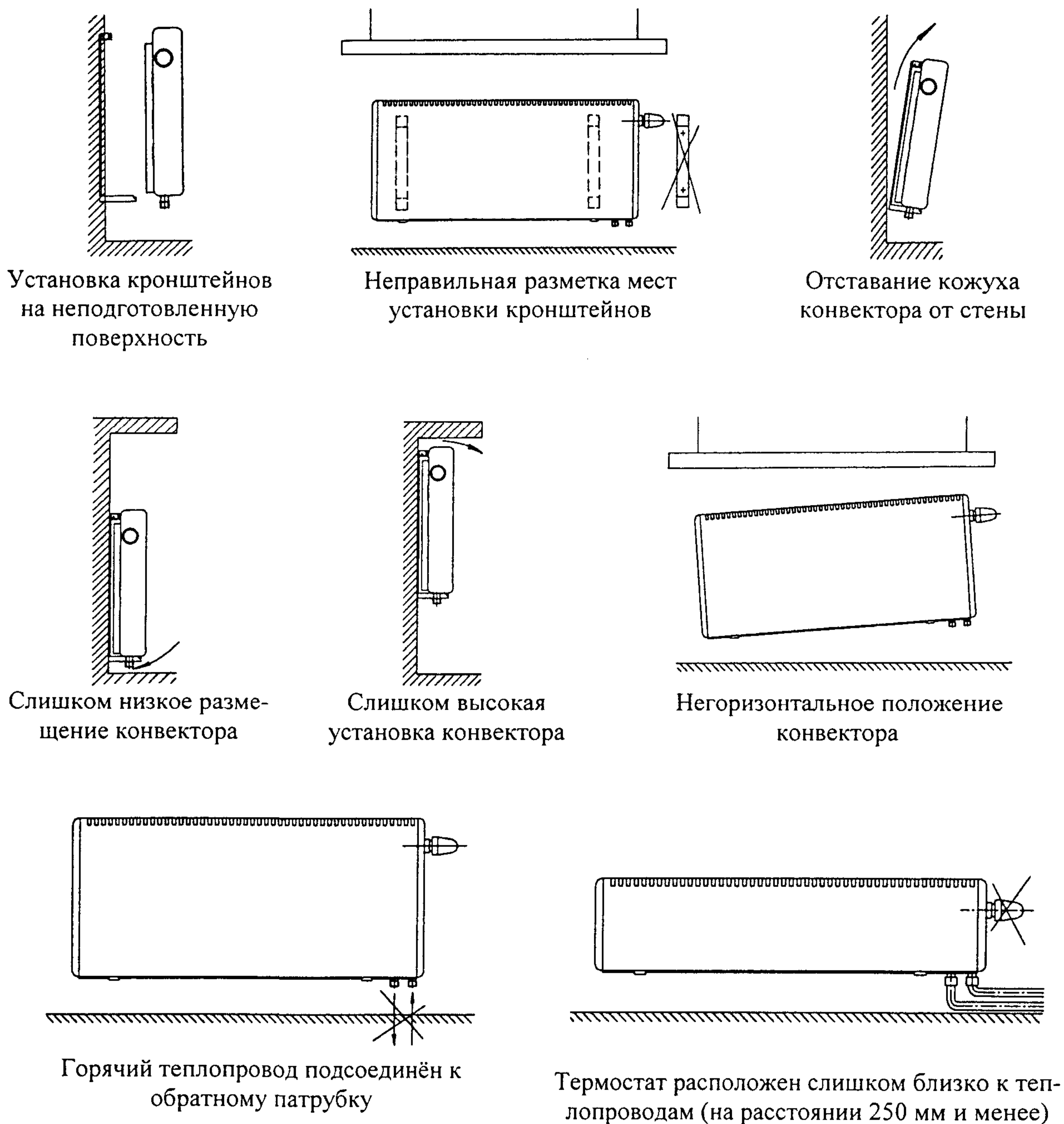
Рис. 6.2. Случаи неправильной установки конвекторов «Экотерм»
